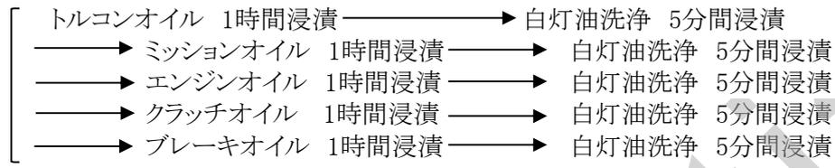
また別のサンプルを用いて、 $50 \pm 2^\circ\text{C}$ のウォッシュ液 (市販のもの) ロングライフクーラント (LLC) を使用し、次の順序で試験を行う。
