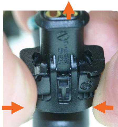
Abbildung 8: Rastelement von der Rastnocke lösen
