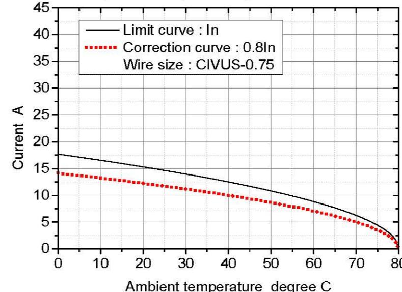
備考：軽減曲線 作成手順は IEC 60512-5-2 TEST 5-b による
